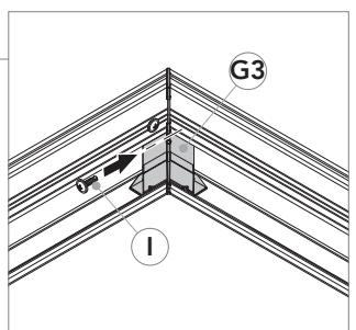
Sichern Sie die OneFrame Außencke mit einer TEK-Schraube.
