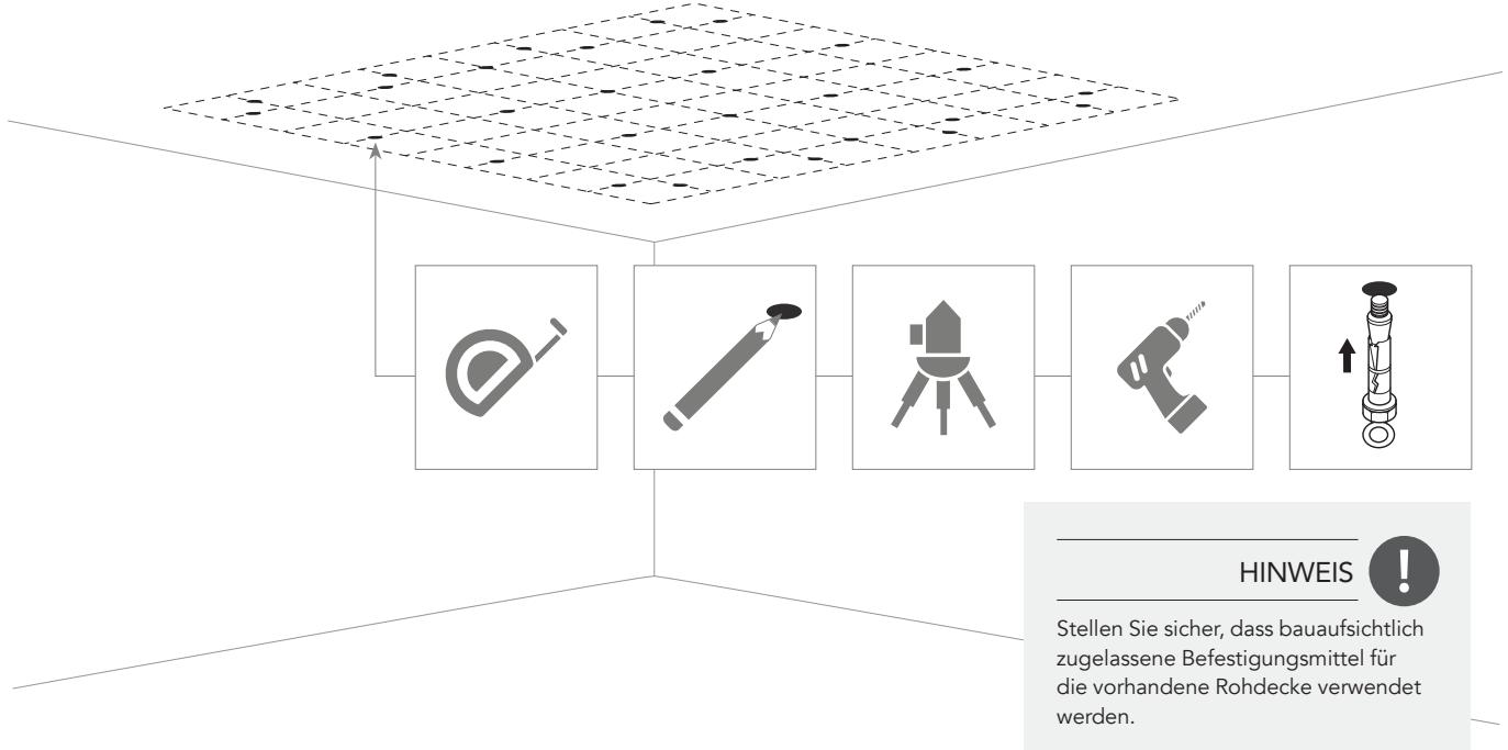
**3** Befestigen Sie die Schnellabhänger an den Befestigungspunkten der Rohdecke.
